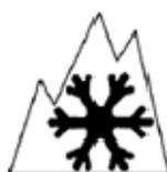
Il simbolo deve avere le seguenti dimensioni minime: 15 mm di base e 15 mm di altezza, ed essere posizionato in prossimità della designazione del tipo M+S. Il disegno sopra riportato non è in scala.
