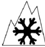
Il simbolo deve avere le seguenti dimensioni minime: 15 mm di base e 15 mm di altezza, ed essere posizionato in prossimità della designazione del tipo M+S. Il disegno riportato non è in scala.
