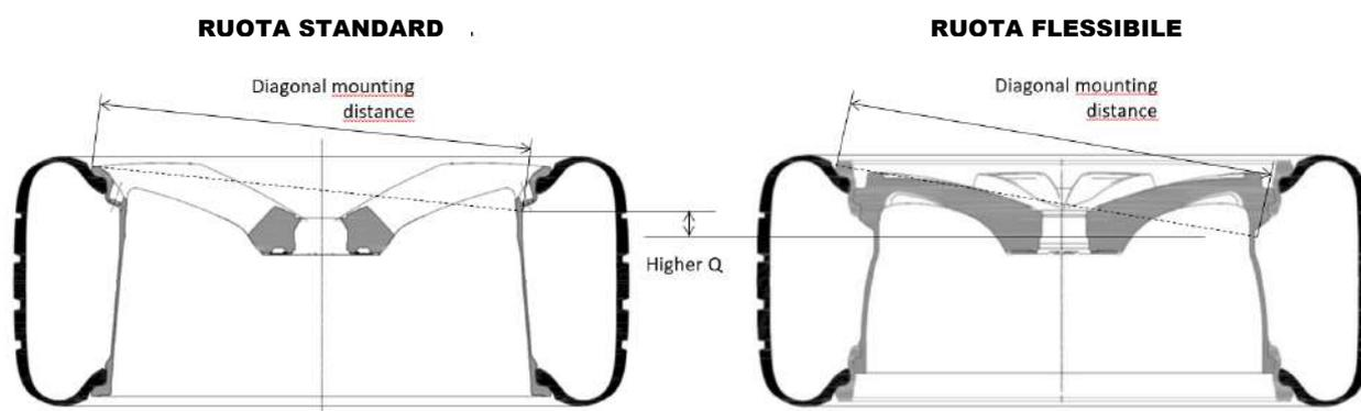
Ogni volta che viene sostituito un pneumatico, le flange flessibili della ruota, il corpo metallico e il pneumatico devono essere controllati per verificare l'assenza di un'usura anomala o di danni. Le flange flessibili devono essere lubrificate, così come i talloni del pneumatico, utilizzando esclusivamente un lubrificante approvato dal costruttore del pneumatico.
