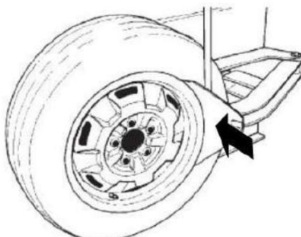
Quando si smonta il pneumatico, quest'ultimo potrebbe attaccarsi alle flange della ruota flessibile. Si consiglia di spruzzare un lubrificante tra il tallone e il cerchio, dopo aver sgonfiato il pneumatico, e di lasciarlo agire per circa 5 minuti nell'area in cui si verifica l'incollamento. Non è consentito utilizzare uno strumento che possa danneggiare la flangia flessibile della ruota.
