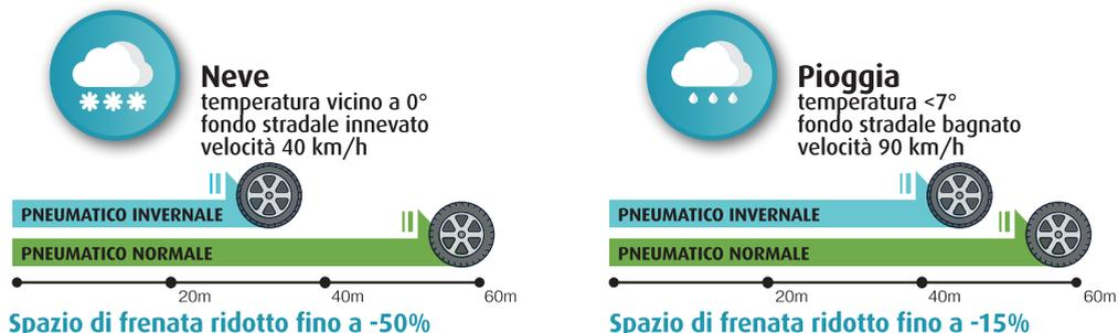
Gli spazi di frenata fanno riferimento ad una vettura di media cilindrata dotata di ABS equipaggiata con pneumatici nuovi.
